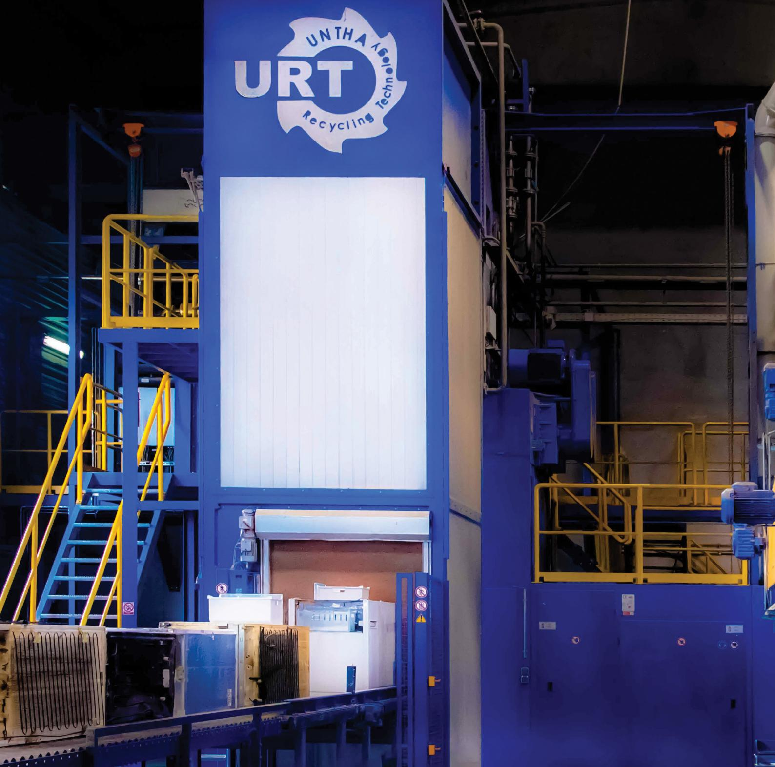
**Postrojenje za obradu velikih rashladnih uređaja** omogućuje materijalnu oporabu te izdvajanje CFC spojeva (freona) u potpuno kontroliranim uvjetima. Na taj način zadovoljava najviše standarde zaštite okoliša, posebice uzimajući u obzir kako je sastavljeno od najboljih raspoloživih tehnologija, a njime u Zagrebu upravlja CE-ZA-R d.o.o. u skladu s ovlaštenjem za sakupljanje i obradu EE otpada. Jedino je postrojenje takve namjene i karakteristika u Hrvatskoj.
